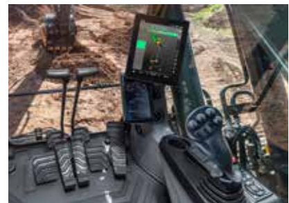
Dig Assist, gesteuert von Volvo Co-Pilot
