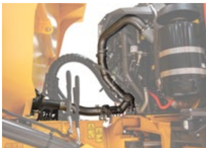
Aquecimento da caçamba com gases de escape
