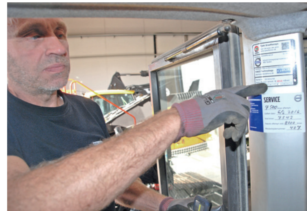
▲ Når en maskine har været gennem et lovpligtigt eftersyn, sættes en mærkat på med dato og et unikt nummer, som maskinen også registreres under i BygKo-registret.
