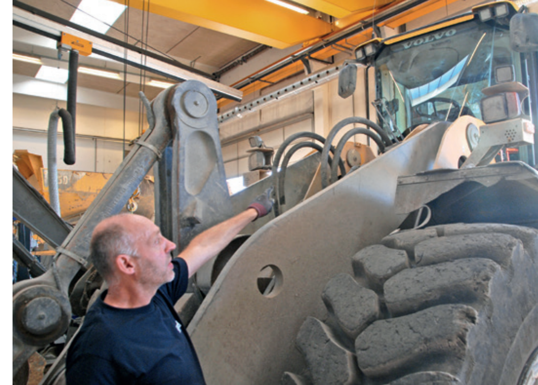
▲ Hydraulikslanger er ekstra udsat, når de sidder i direkte sollys. Det påvirker slangernes overflade.
