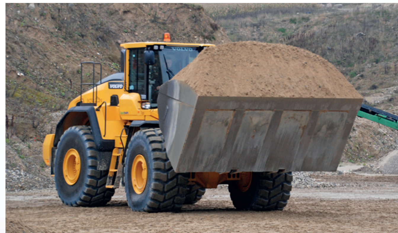
▲ KR Grus har fået bygget en Volvo-skovl efter egne ønsker til den nye læssemaskine. Den har en længere bund end standard.
