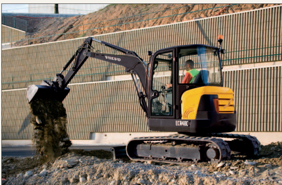
Figura 1 - Il miniescavatore ECR48C con sovrastruttura a corto raggio che cambia la larghezza dei carri
