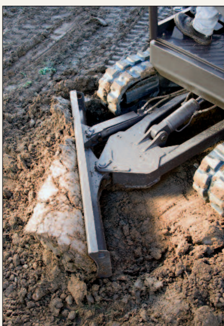
Figura 2 - Il meccanismo della lama dozer dell'ECR48C
