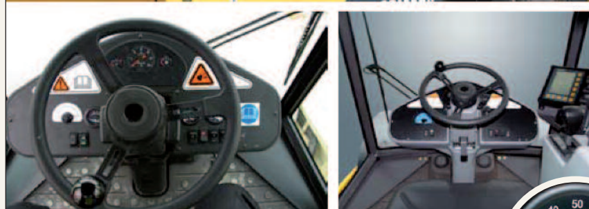
Figura 3 - Soluzioni ingegnose che facilitano il lavoro quotidiano: una cabina spaziosa, dall'eccellente isolamento dai rumori e dalla confortevole ammortizzazione (opzionale); una console con gli strumenti comprende i comandi direzionali, il comando per l'attivazione/disattivazione delle vibrazioni, la presa di corrente, l'arresto di emergenza, il portabicchieri e il vano portaoggetti; il sedile, con sospensioni Premium, è completamente regolabile e ha base girevole; strumenti e interruttori sono posizionati comodamente sul piantone dello sterzo; una climatizzazione opzionale; cicalino e spie per il motore, la pressione dell'olio, la temperatura refrigerante, la temperatura dell'olio idraulico e le restrizioni del filtro dell'aria; il piantone per uno sterzo ribaltabile; due luci di lavoro anteriori e due posteriori
