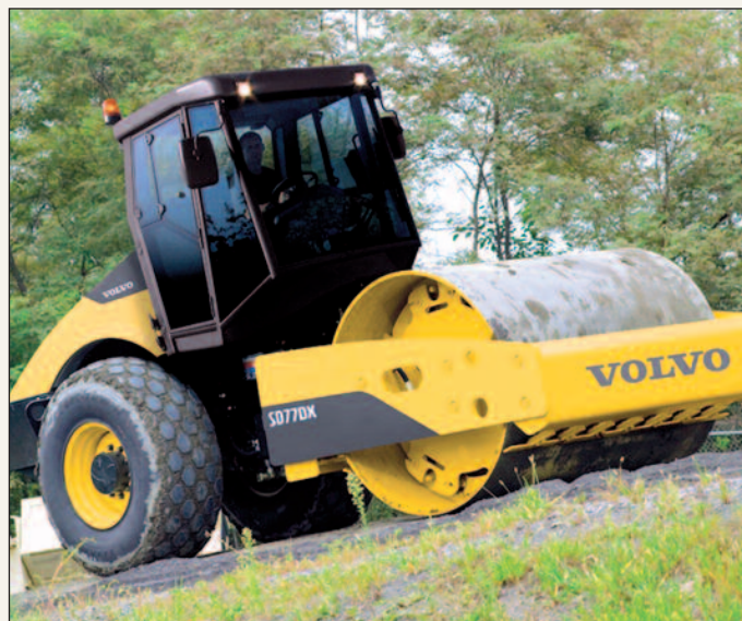
Figura 4 - Tutti i compattatori della serie SD hanno il baricentro basso, che ne aumenta la stabilità, anche sulle pendenze più ripide
