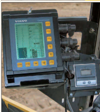
Figura 2 - Il CompAnalyzer fornisce una documentazione completa sul processo di compattazione. Il sistema visualizza infatti i dati relativi a un massimo di 350 km di passate
