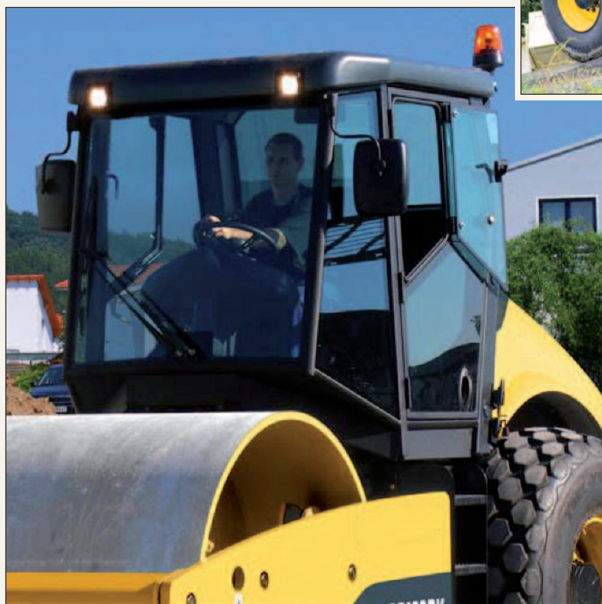
Figura 4 - Tutti i compattatori della serie SD hanno il baricentro basso, che ne aumenta la stabilità, anche sulle pendenze più ripide
