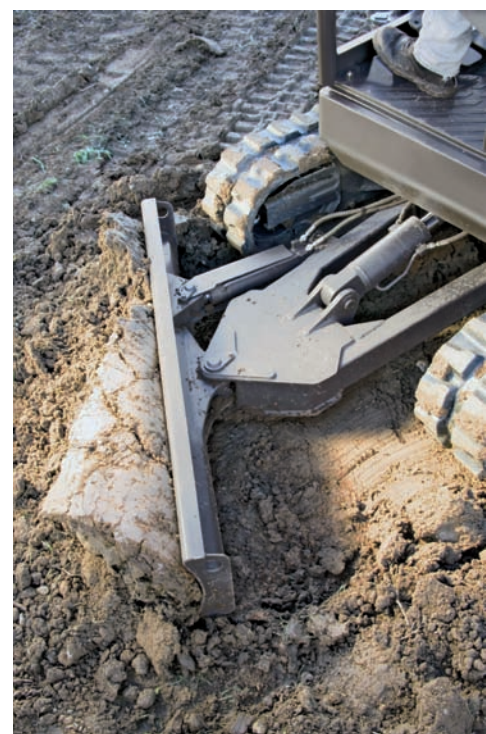
La lama angolare idraulica ruota consentendo un risparmio di tempo
