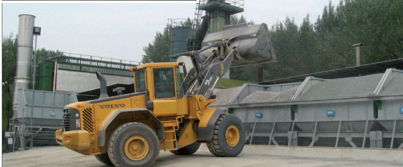
Figura 5 - Una pala gommata Volvo mentre carica le tramogge di stoccaggio degli inerti
