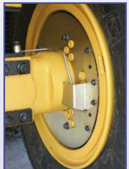
■ Il sistema frenante prevede un impianto a doppio circuito con freni a disco a secco
