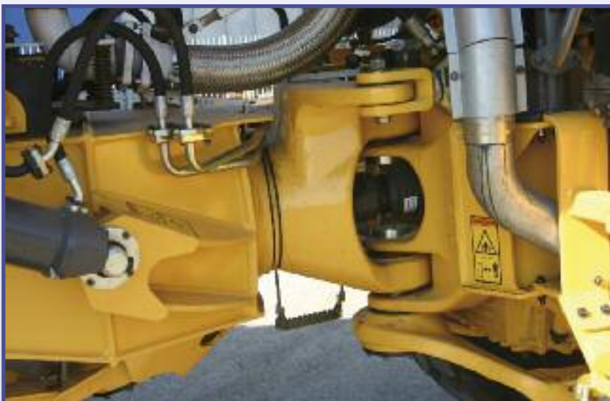
■ La particolare collocazione dello snodo centrale garantisce un'elevata luce da terra, per una maggiore protezione e stabilità
