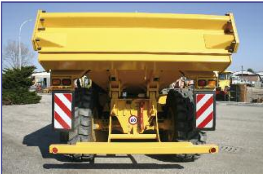
■ L'ingombro laterale della macchina rimane contenuto entro i 3.000 mm, sia nella versione con cassone standard che in quella con sponda posteriore a fune, disponibile in via opzionale
