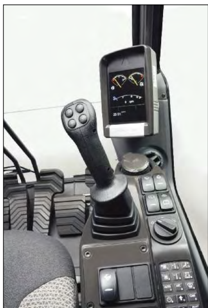
■ Il joystick di comando in cabina è disponibile anche nella versione a basso sforzo dei polsi, con comandi proporzionali
