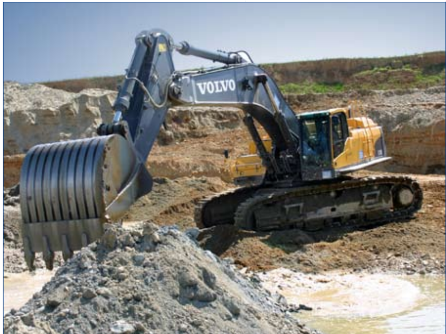
■ L'escavatore cingolato Volvo EC700 C, adibito alla coltivazione di cava
