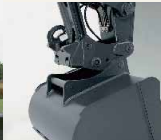
• Schnellwechsler: einfacher Gerätewechsel von der Kabine aus.
