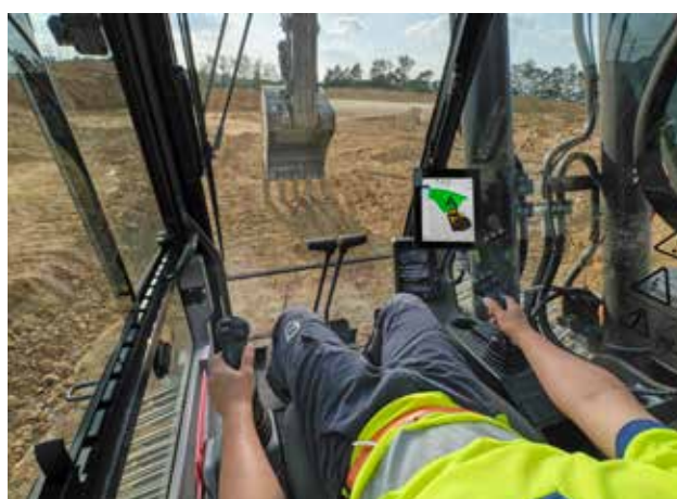
Aplikacje Dig Assist współpracujące z systemem Volvo Co-Pilot (asystent operatora Volvo)
