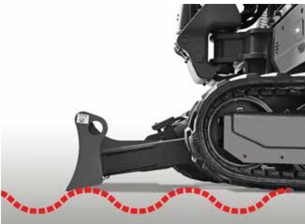
Schaktblad med flytfunktion
