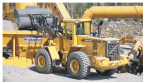
En av upplagslastarens mest vanliga arbetsuppgifter – att mata en ficka.
