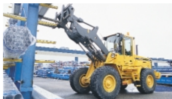
Det siktoptimerade redskapsfästet och det vidareutvecklade TP Linkage ger utmärkt sikt över både redskap och last.
