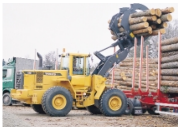
TP Linkage lämpar sig utmärkt för timmerhantering. Inget annat lyftarmssystem ger ett så högt brytmoment i hela lyftområdet.
