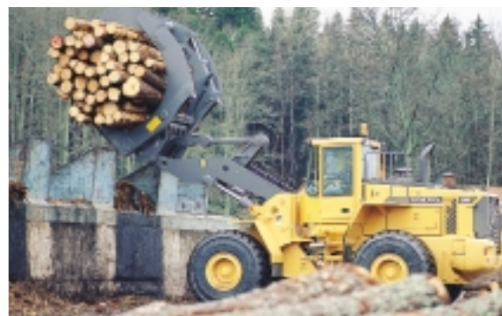
TP Linkage lämpar sig utmärkt i timmerhantering. Inget annat lyftarmsystem ger ett så högt brytmoment i hela lyftområdet.
