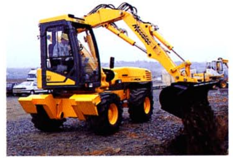
Rückverfüllung 90° zur Fahrtrichtung - Der Fahrer hat direkte Sicht auf seine Arbeit
