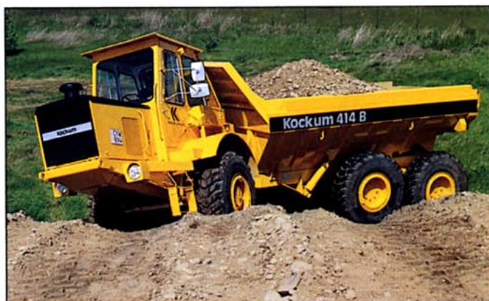
Fjädring, 6-hjulsdrift, pil-boggie, lock-up och inkapslade lamellbromsar ger Kockum 414B unika egenskaper vid körning i svår terräng.
