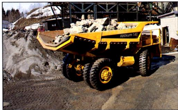
Kockum 540 kan utrustas med specialkorg försedd med gummibotten (Rubber Body), vilket ökar lasteffektiviteten samtidigt som ljudnivån vid lastning och lossning sänks avsevärt.
