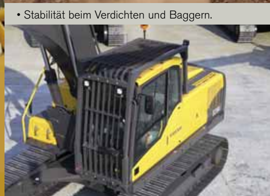
• Rahmenmontiertes FOG-Schutzgitter für den Fahrer.
