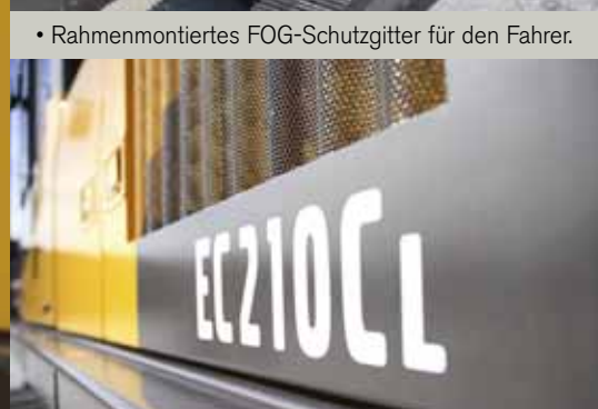
• Kühlerschutz durch feinmaschige Lufteinlassgitter.
