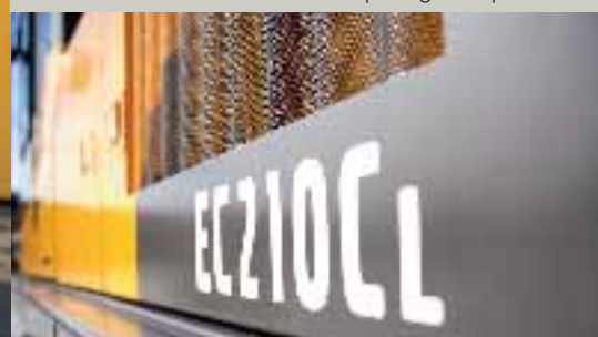
• Las pantalla de microfibra evitar que las partículas penetren en los refrigeradores.
