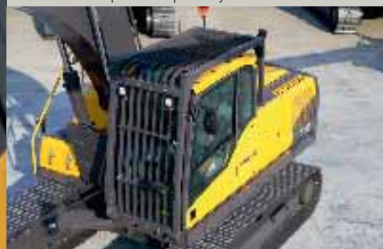
• La FOG montada en bastidor protege al operador.
