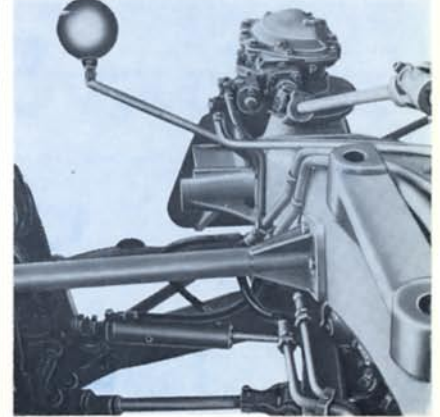
Hydraulisk hjälpstyrning med mekanisk känsel. Den mekaniska styrningen fungerar oberoende av den hydrauliska hjälpstyrningen.
