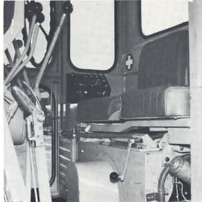
Förarsitsen inställbar i höjd- och längdled efter individuella önskemål. Instrumentpanel — överskådligt placerad.
