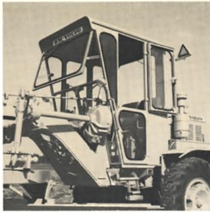
Lutad frontruta ger god överblick över arbetsorganen och det framdragna taket tjänstgör som solskydd. Frontruta och övre delen på dörrarna är låsbara i öppet läge.
