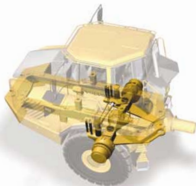
Trepunktsupphängningen består av robusta komponenter. En enkel hållbar konstruktion som ger den bästa åkkomforten.
