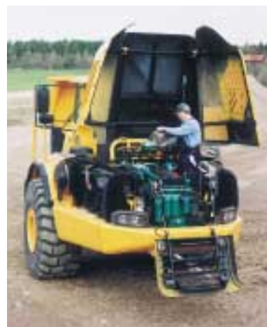
L'accès au compartiment moteur entier est très aisé grâce au nouveau capot moteur. Des marches sont incorporées dans la calandre frontale pour accéder très facilement aux différents points de service.
