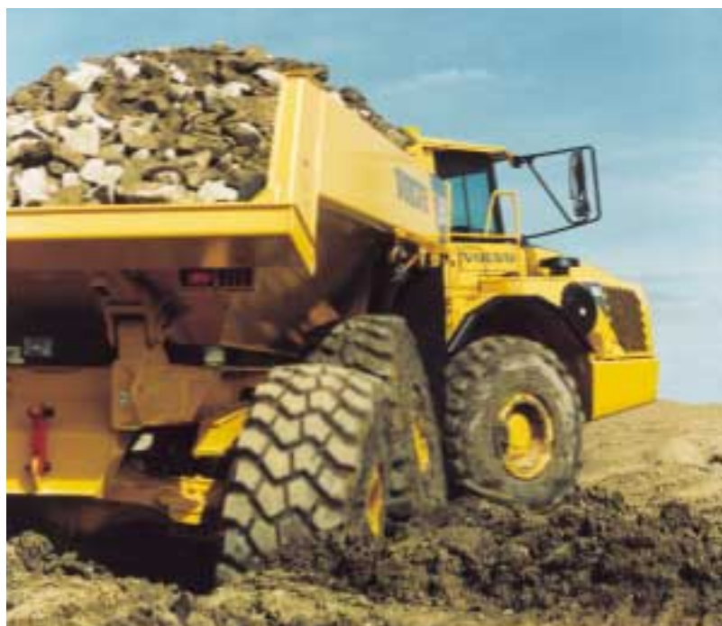
Die selbstausgleichende hydromechanische Lenkung macht das Lenken des Dumpers mit dem eines Pkw vergleichbar.
