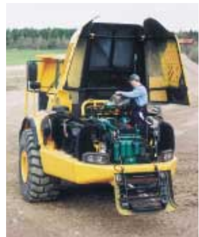
Dank neuer Motorhaube ist der Zugang zum gesamten Motorraum hervorragend. Im Frontgrill integrierte Stufen machen die Erreichbarkeit verschiedener Servicepunkte besonders einfach.
