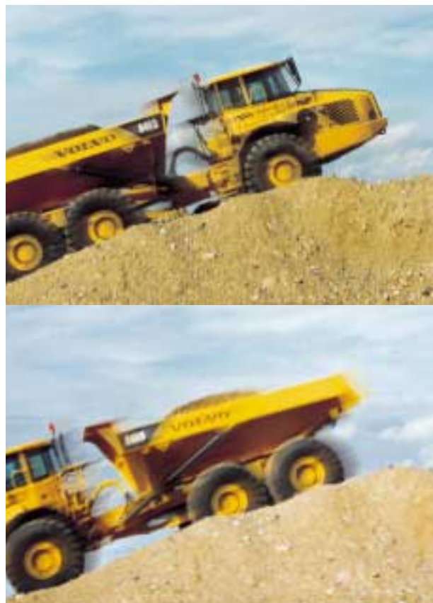
Die Volvo-Motorbremse und der hydraulische Retarder bieten exzellente Verzögerungsleistungen.
