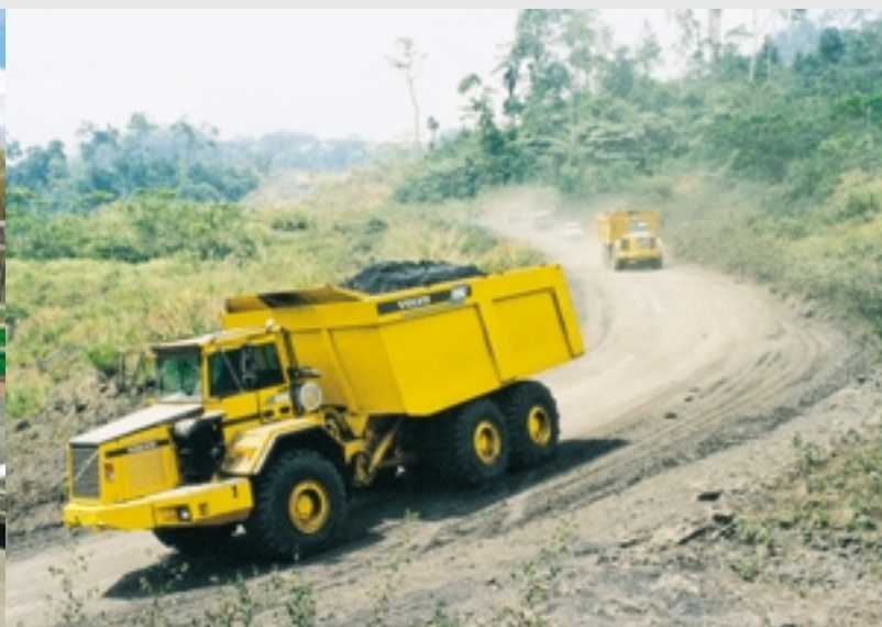
På Sumatra, Indonesien, använder operatören P.T Bukit Sunur A35C Coal Hauler för att transportera kol. Korgen är specialbyggd för material med låg densitet och rymmer hela 36 kubikmeter.
