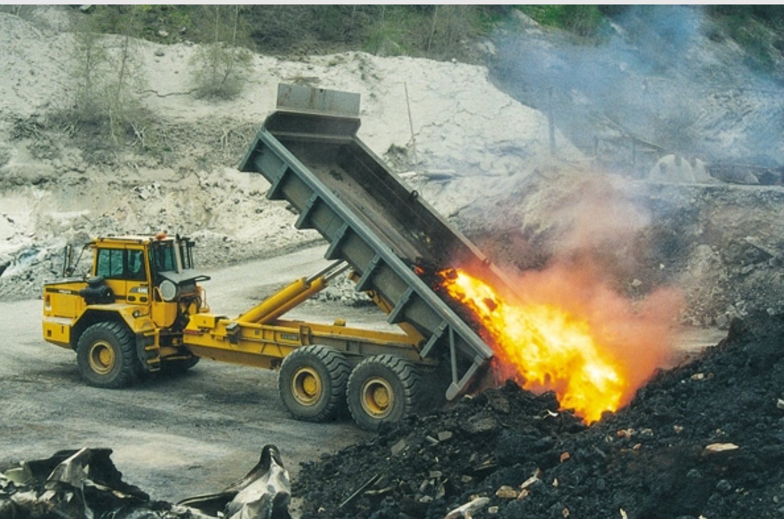
A30C 6x6 Hook Lift som används av Horn&Co hos Krupp (Edelstahlprofile) GmbH i Siegen, Tyskland. Maskinen används först och främst till att transportera slagg, men kan också användas för andra typer av transporter på stålverket tack vare lastväxlersystemet.
