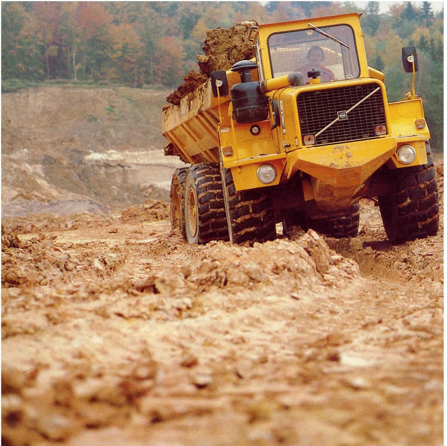
Dumpern på bilden är utrustad med en extra luftrenare.
