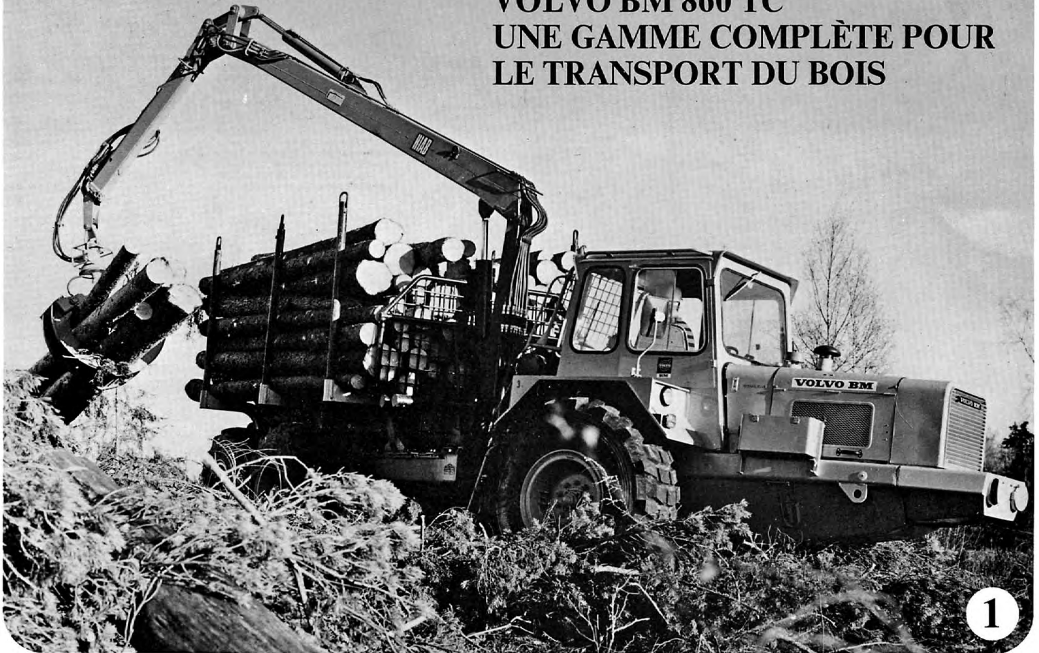
VOLVO BM 860 TC — PORTEUR-REMORQUEUR POUR TRONCS ENTIERS
