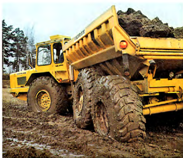
Boggiens drivakslar er fremstillet til hård kørsel. Den er forsynet med navreduktion og differentialespærre.
