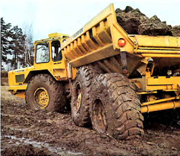
Boggins drivande axel är gjord för hård terrängkörning. Den har navreduktion och differentialspärr.
