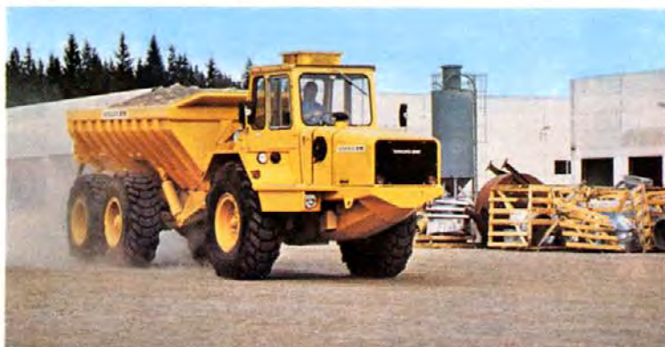
La cabina, molto alta, dispone di ampia finestratura, e permette quindi un'ottima visibilità: anche questo è un fattore di sicurezza.
