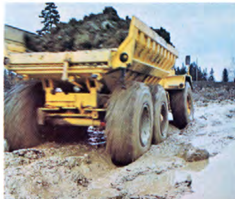
La trazione sulle 4 ruote ed il bloccaggio dei differenziali possono essere inseriti e disinseriti anche durante la marcia, e quindi il dumper è in grado di affrontare improvvisi ostacoli senza diminuire la velocità.
