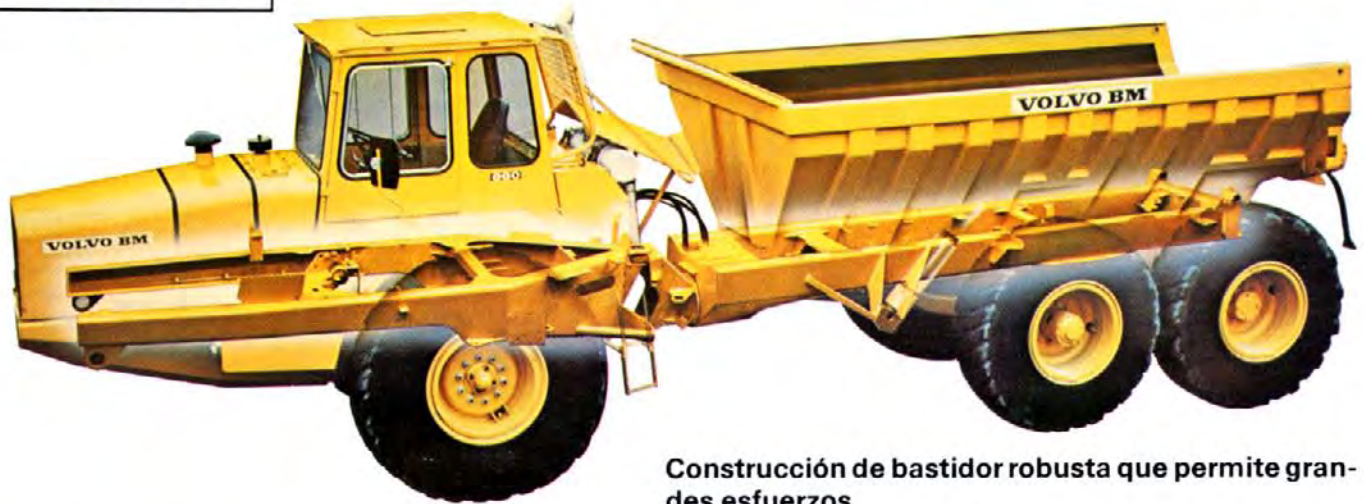
El cilindro de tiro que une las unidades motriz y de carga permite basculamiento infinito.
