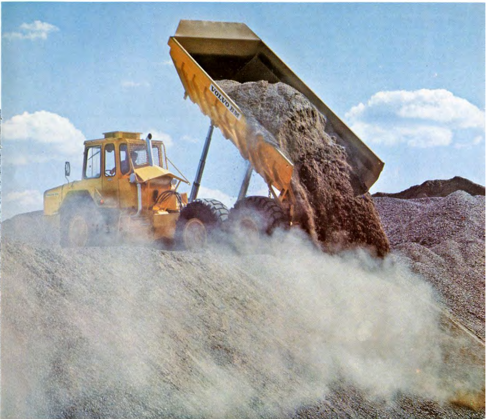
Vaciado rápido gracias al gran ángulo de volcado - 70° - y un sistema hidráulico eficaz.
