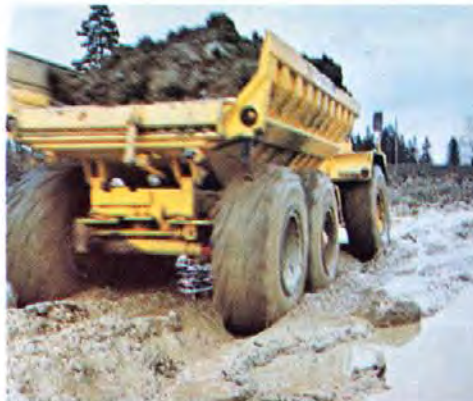
Tanto la tracción a 4 ruedas como los bloqueadores de diferencial pueden ser conectados y desconectados durante funcionamiento – de esta manera la máquina mantiene su velocidad cuando entra en tramos difíciles.
