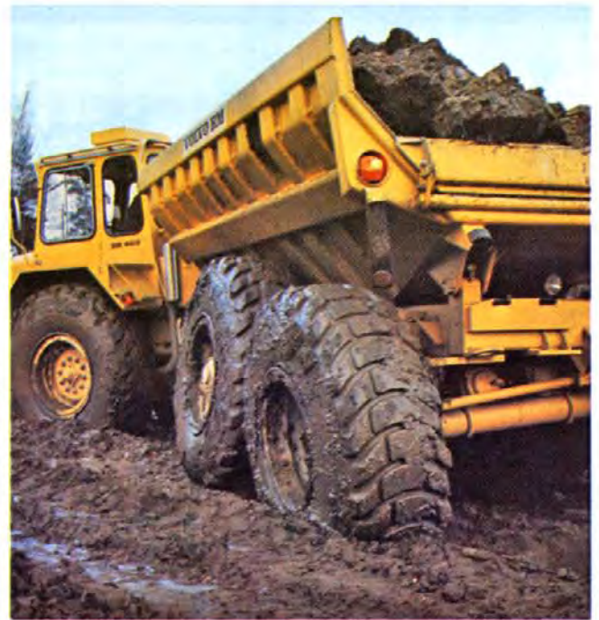
Derrames mínimos, la caja de carga "flota" sobre el bogi que elimina las irregularidades.
