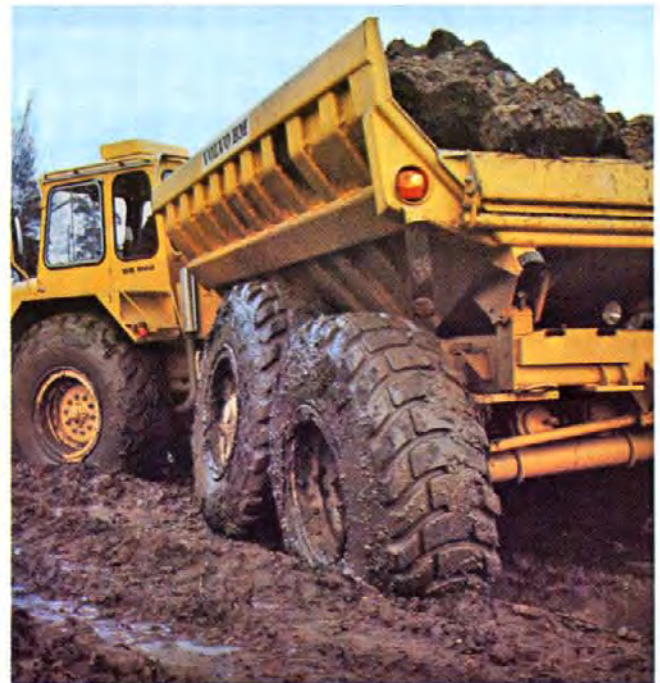
Minimaal morsen: de laadbak "zweeft" als het ware over het terrein doordat de bogie de oneffenheden in het terrein verwerkt.
