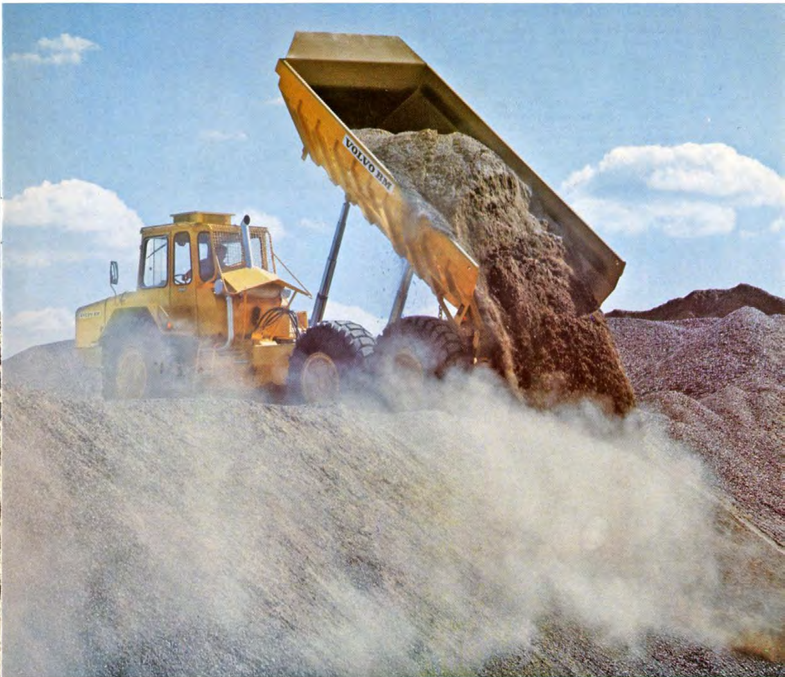
Große Kippzylinder und ein Auskippwinkel bis zu 70° sorgen für schnelle Entleerung der Mulde.
