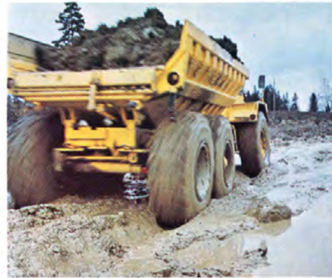
Der Allradantrieb und die Differentialsperren können während der Fahrt ein- und ausgeschaltet werden. Schwierige Geländepassagen können deshalb ohne vorheriges Anhalten mit Schwung durchfahren werden.
