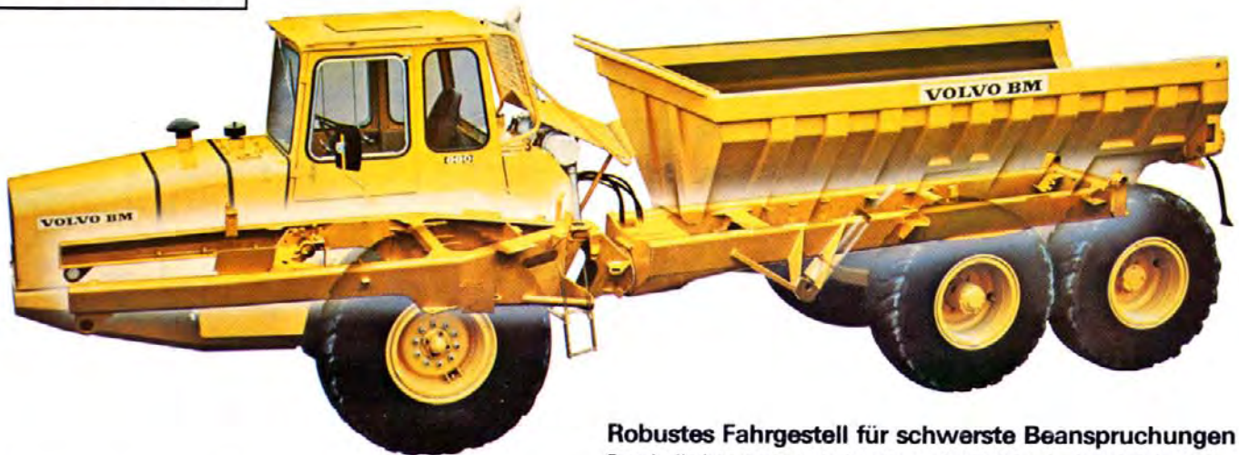
Bei Bodenunebenheiten bleibt die Mulde dank der Tandemachse horizontal – kein Verlust von Material.
