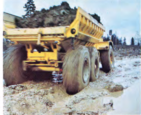
Nelipyörävetö ja tasauspyörästölukot voidaan kytkeä ajon aikana kiinnijuuuttumisen ennaltojumiseksi.
