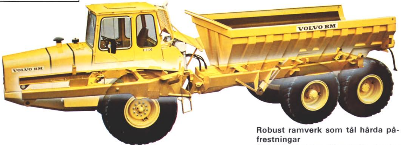
Dragcylindern som förbinder motor- och lastenhet medger ändlös skevning.
