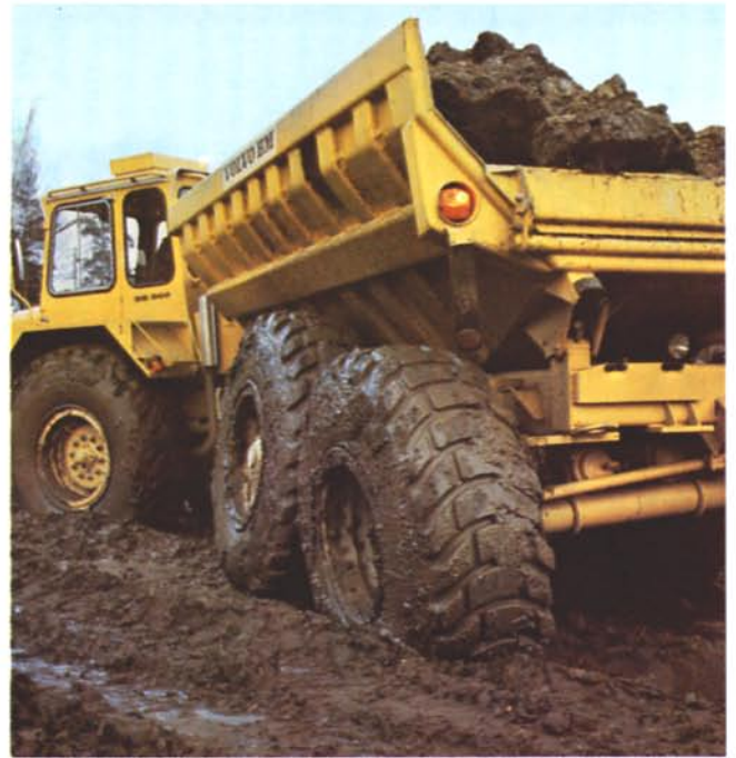
Minirullspill, lastkaret "flyter fram" över den terrängutjämnade boggin.
