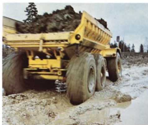
4-hjulsdriften såväl som differentialspärrarna kopplas in och ur under gång – maskinen behåller därigenom farten när den går in i svåra passager.
