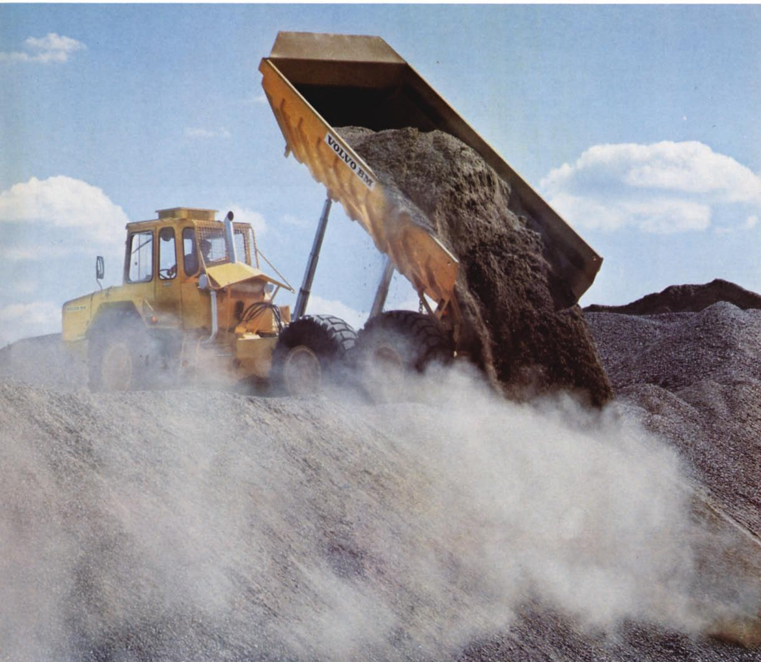
Snabb tömning genom en stor tippvinkel – 70° och en effektiv hydraulik.
