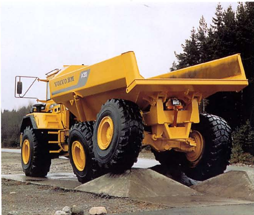
Le système Volvo BM de pont flottant permet le passage d'obstacles importants sans perturbation de la benne.
