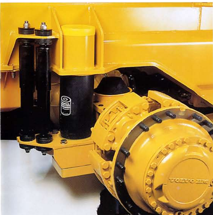
Le système de suspension du pont avant procure au conducteur un excellent confort même sur les terrains les plus accidentés.
