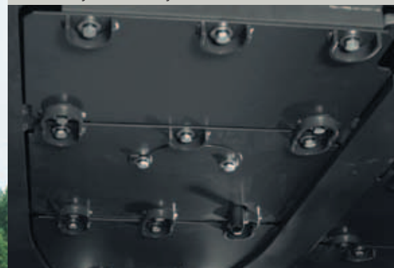
• Нижний кожух на болтах для защиты при работе в неблагоприятных условиях
