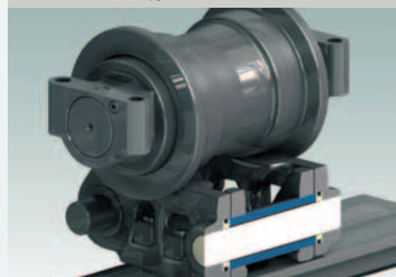
• Пальцы звеньев гусеничной цепи являются необслуживаемым узлом
