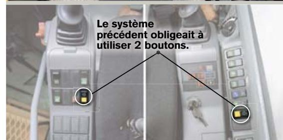
• Avec un commutateur unique pour la fixation et le verrouillage du godet, le système de porte-outil série C améliore encore la sécurité et la productivité.
