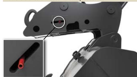
• L'indicateur équipant le porte-outil SQF permet de savoir si le godet est verrouillé.
