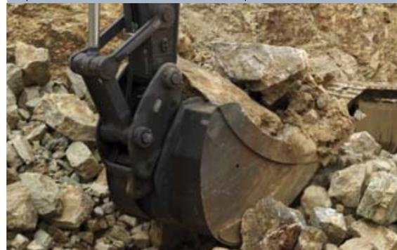
• Les godets spéciaux roche sont réalisés dans une tôle encore plus épaisse que la version HD et équipés de dents AMRE longue durée résistant à l'abrasion.
