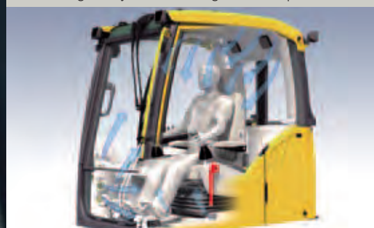
• Branschens största värme/kylkapacitet med 14 munstycken.
