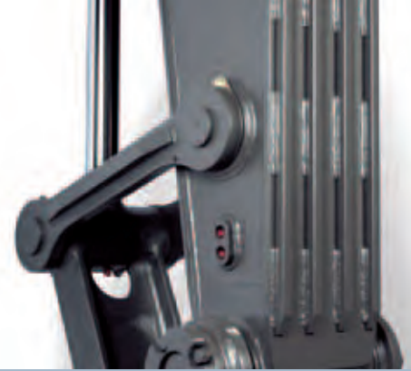
• Skyddad skafftinsida med axialspelsjustering.
