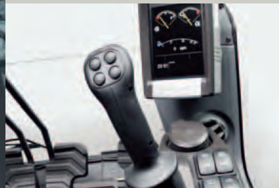
• LCD-Farbmonitor und Bedienelemente – ergonomisch günstig angeordnet.
