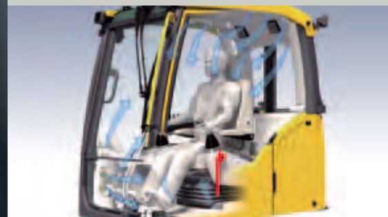
• Hohe Heiz- und Kühlleistung – über 14 Luftdüsen optimal verteilt.
