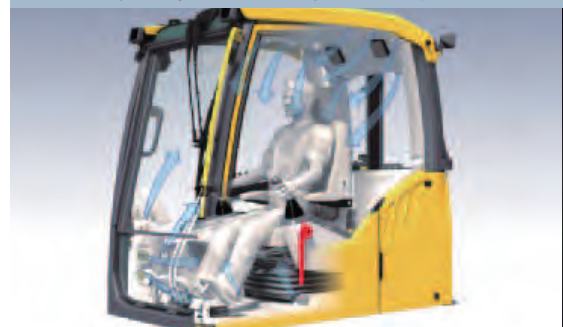
• Branschens största värme/kylkapacitet med 14 munstycken.
