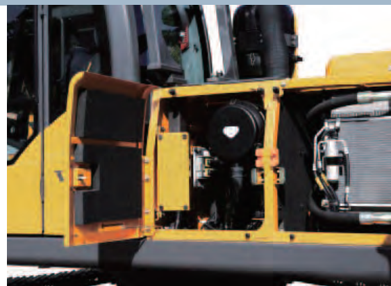
• Accesso facilitato per la manutenzione da terra.
