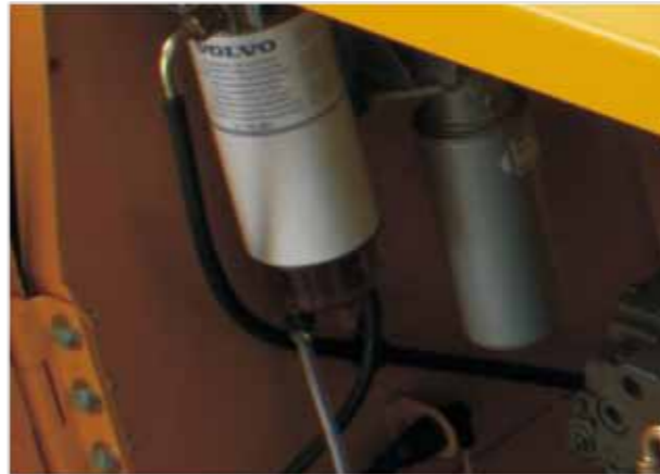
油水分离器报警，针对国内柴油含水率高湿度高昼夜温差大的特点，机器配置了油水分离器报警功能，提醒驾驶员及时对油水分离进行放水
