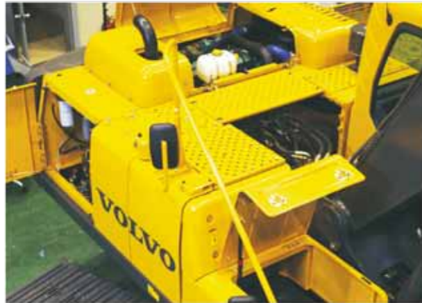
大尺寸全开门设计，上部车体所有需要检查保养的位置均开有宽阔结实的舱盖，方便人员接近。同时这些舱盖还配有坚固耐用的自动锁定装置，让您的机器日久如新
