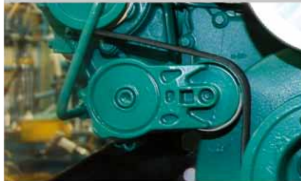
发动机皮带自动涨紧轮，自动涨紧发动机皮带，张紧度可调，发动机保养更简单成本更低
