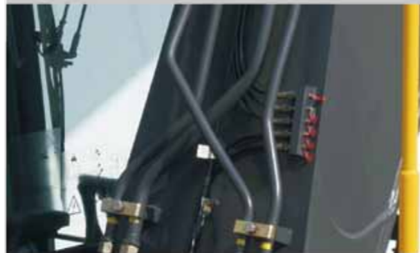
工作装置及回转系统的润滑点集中布置，大幅减低驾驶员的保养工作量，设备也更加可靠耐用
