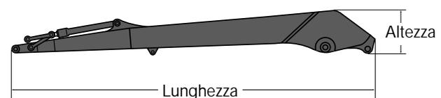
\* Include cilindro, tubi e sistemi di leve
