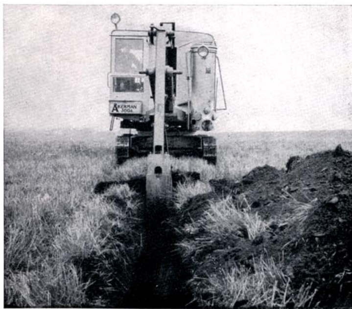
Fig. 4 Åkerman 350 med täckdikesskopa
