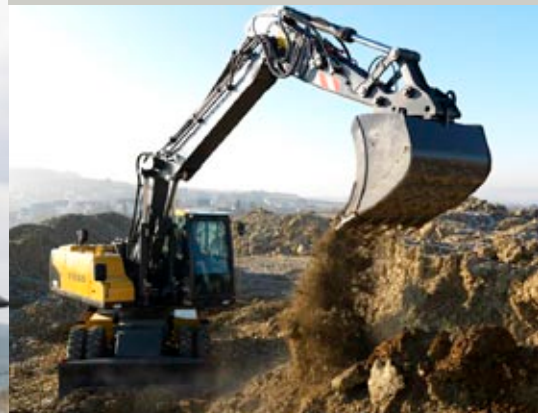
• La flèche articulée permet de gagner en polyvalence.
