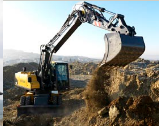
• Verstellausleger erweitert das Einsatzspektrum.
