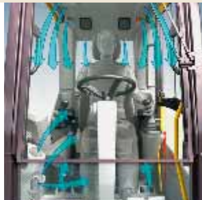
Control electrónico de la climatización
