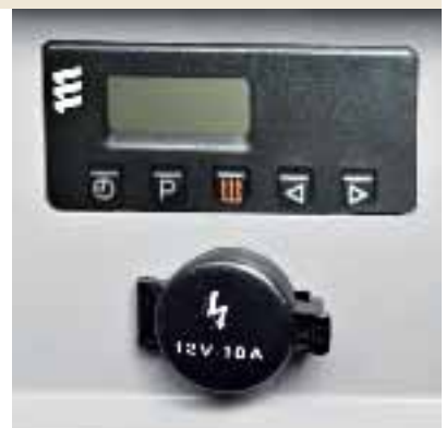
Calentador del refrigerante del motor
