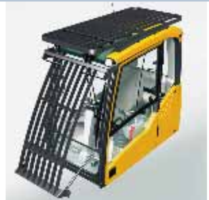
Structure de protection de cabine
