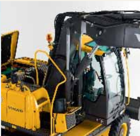
• La flèche articulée permet de gagner en polyvalence.
