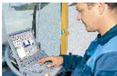
Dados de funcionamento armazenados mostram como a máquina trabalha. A informação pode ser usada como base para a pesquisa de falha e providências de reparo.
