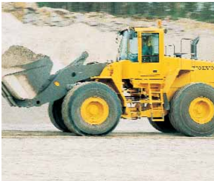
Suspensão do braço de carga / Boom Suspension System (BSS)*
